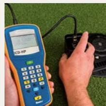
**Kabellose Programmierung der Zwei-Wege-Module von außen ohne Demontage**
