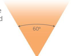
Die Leuchten der FX Luminaire Designer Serie verfügen über integrierte LEDs mit verschiedenen Abstrahlwinkeloptionen für
